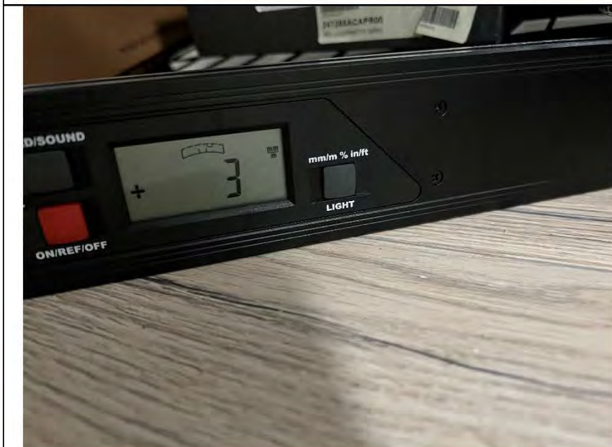
Фото №17. Измерение уровня напольного покрытия в гардеробной.
