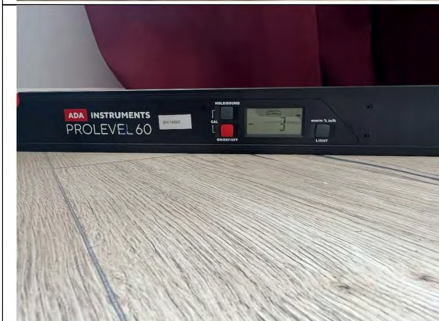
Фото №18. Измерение уровня напольного покрытия в кухне.
