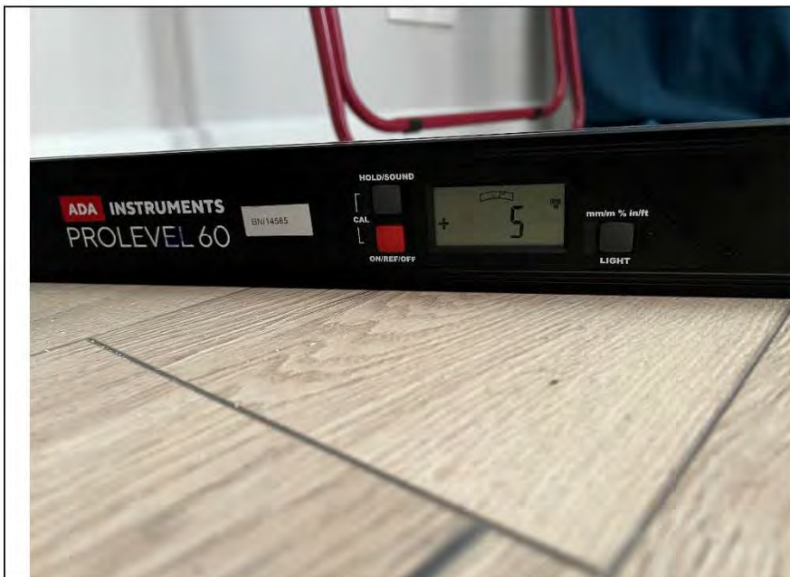
Фото №16. Измерение уровня напольного покрытия в спальне.
